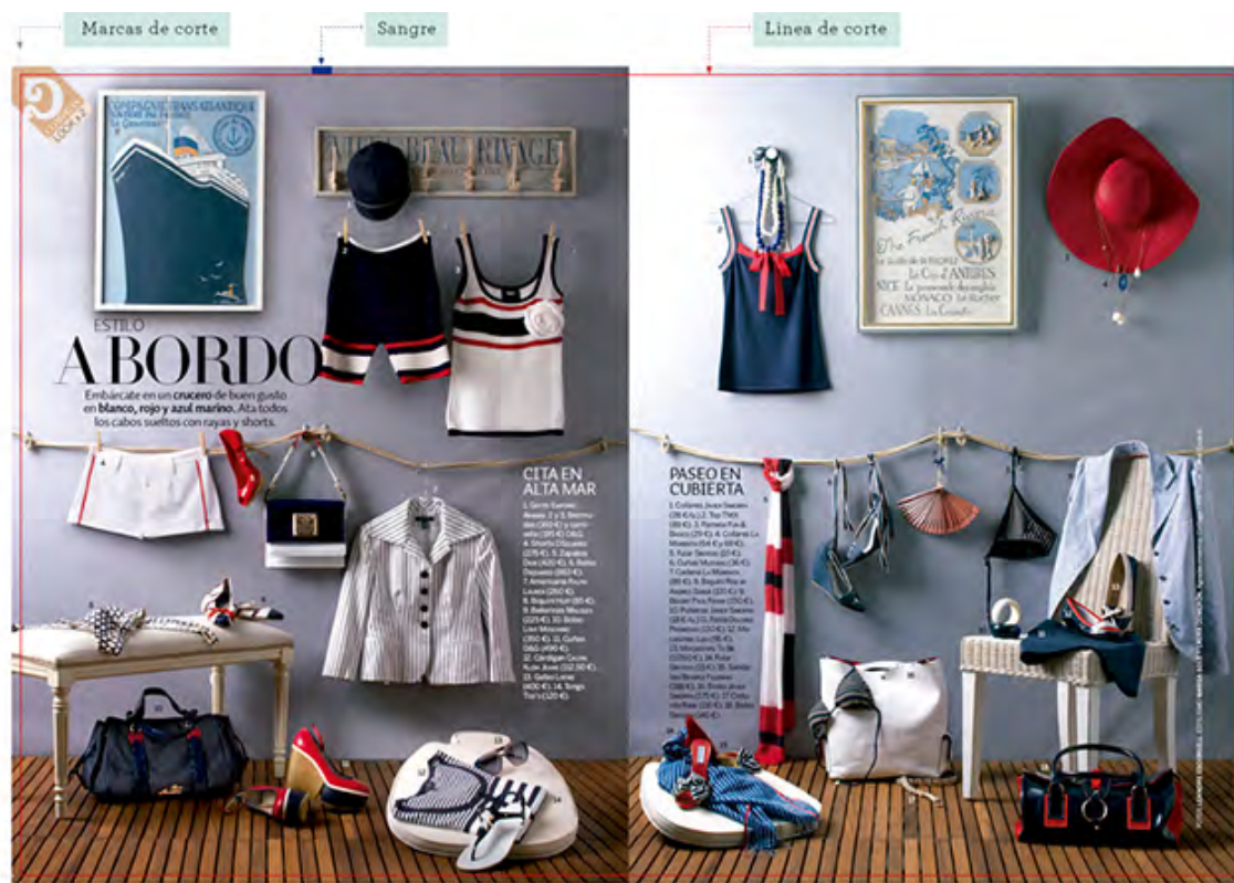
En aquest exemple de PDF llest per a enviar a impremta de la revista Woman podem veure les marques de tall del document i l'espai de sagnat reservat.
