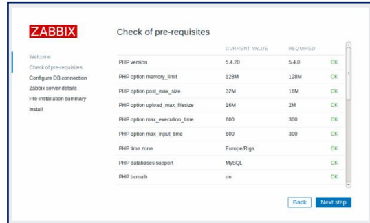
Figura 50. Configuración frontend – Prerrequisitos
