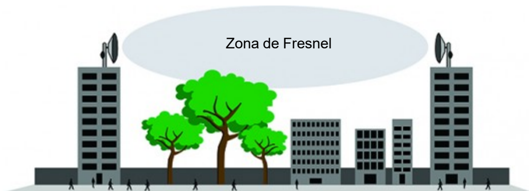
Figura 30: Obstacle que envaeix la zona de Fresnel i que pot provocar interferència del senyal [36]
