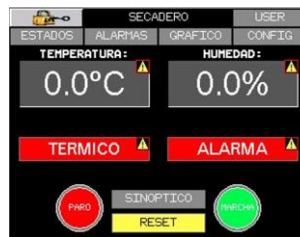
Ilustración 11 : Ejemplo de un HMI. Pantalla táctil de 6,5"
