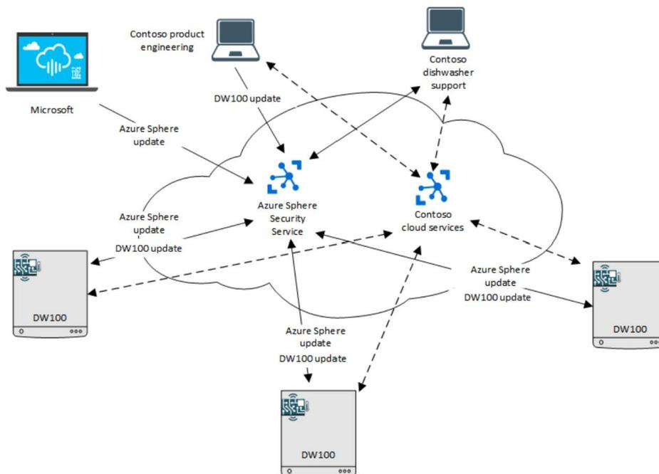
Figura 69 – Ejemplo de entorno de Azure Sphere
