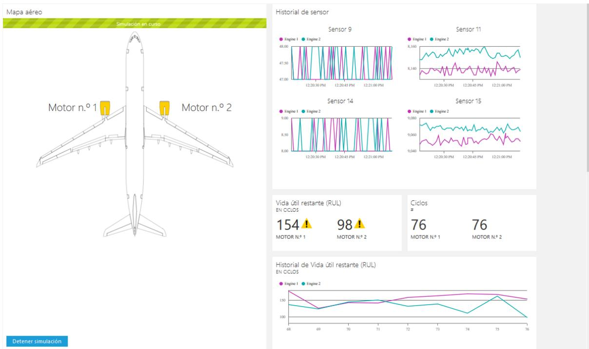
Figura 60 – Aviso de umbral de mantenimiento 2
