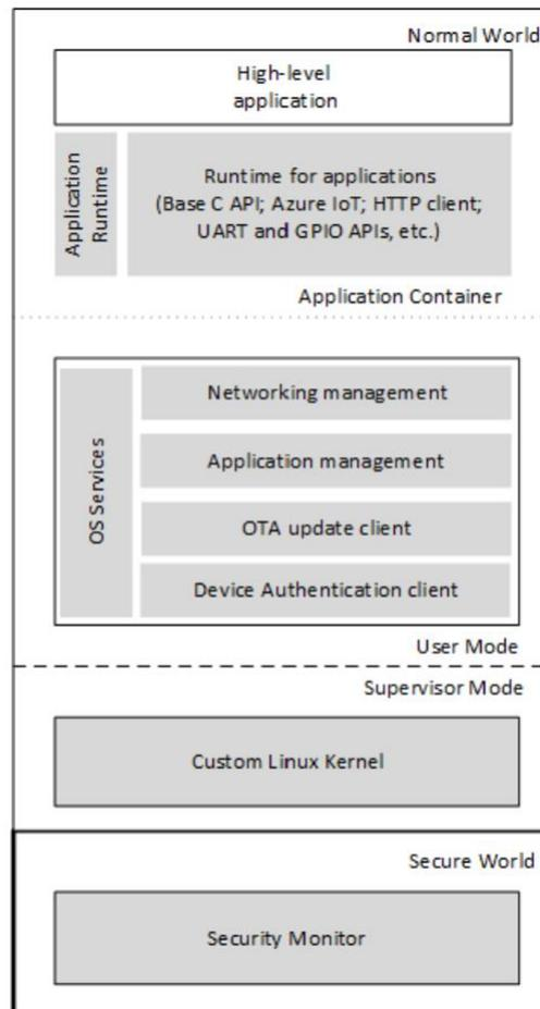
Figura 70 – Arquitectura Software de Azure Sphere
