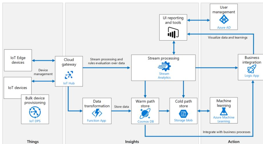
Figura 29 - IoT Arquitectura de referencia en Azure
