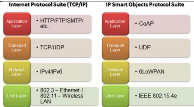
Figura 8 – Estructura de protocolos en IoT
