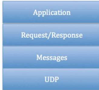
Figura 9 – IoT Estructura de mensaje CoAP
