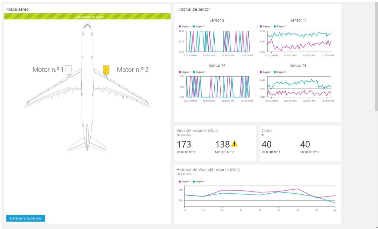
Figura 59 – Aviso de umbral de mantenimiento 1
