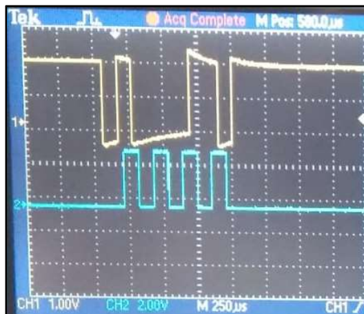
Figura 31. Ajuste de recepción RS232-C con osciloscopio
