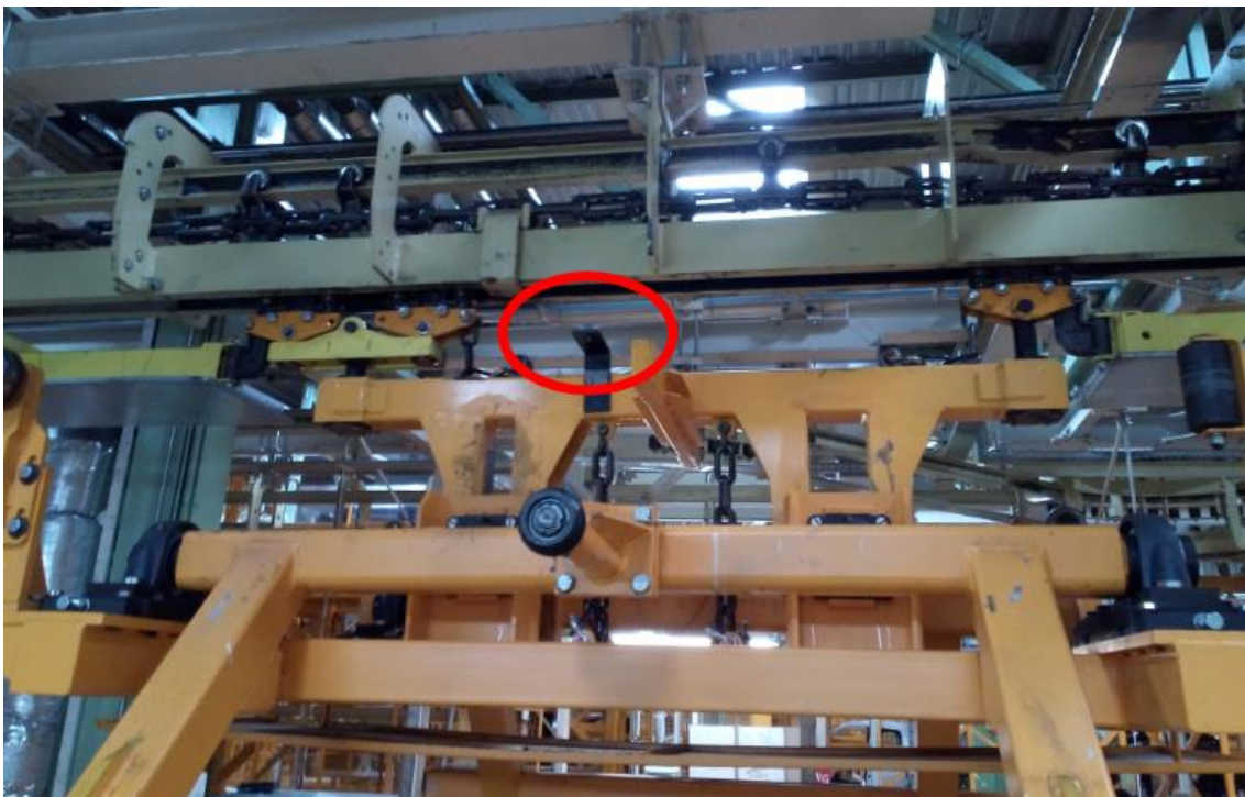
Imatge 56. Vista del Tag instal·lat en el transportador.
