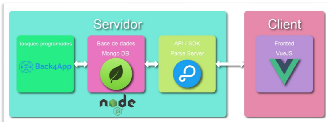
Figura 2. Arquitectura de l'aplicació web
