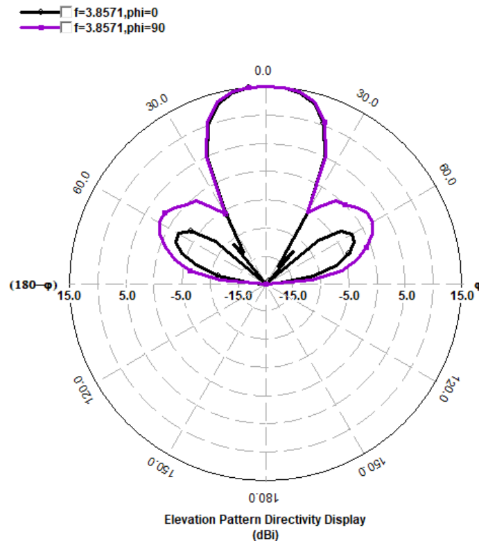
Ilustración 27: Diagrama de radiación de la estructura con dos parches en IE3D
