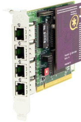
Tarjeta de telefonía Digium TE412P con cancelador de eco hardware Octasic incorporado
