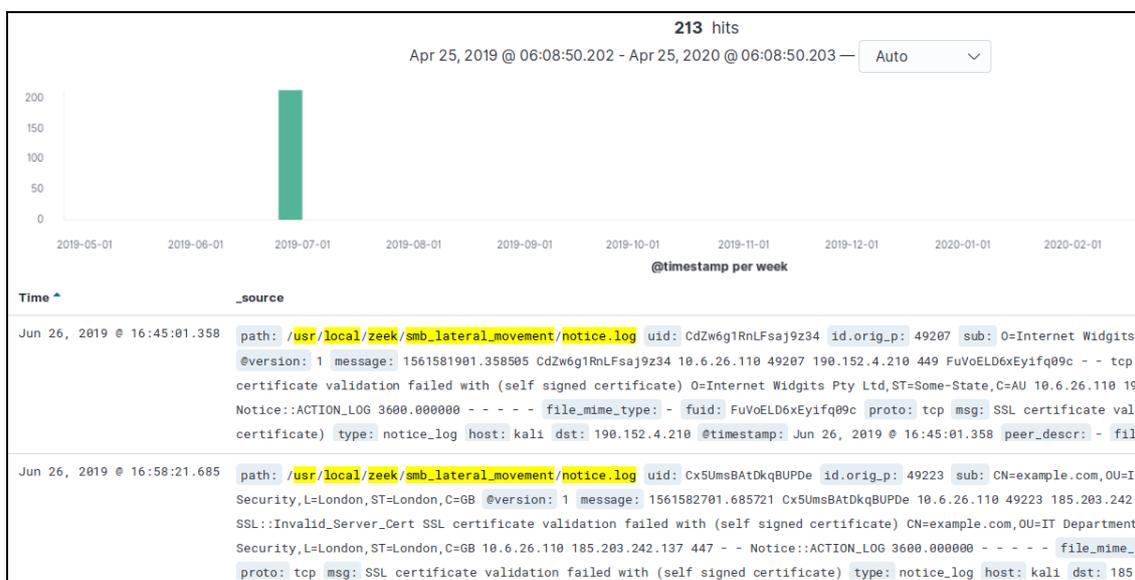
**Ilustración 27. Logs Zeek IDS visibles en Elasticsearch y Kibana. Análisis protocolo SMB.**
