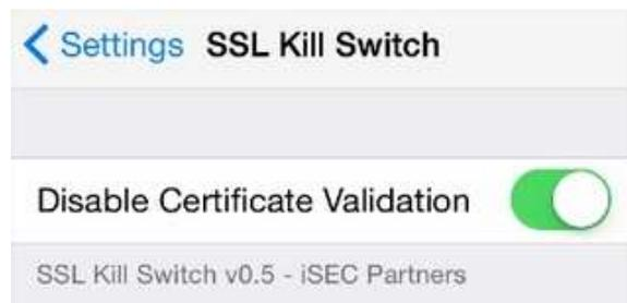
Figura 5: Deshabilitar SSL Pinning en iOS con SSL Kill Switch
