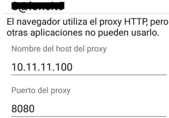
Figura 24: Configuración de proxy en Terminal Android
