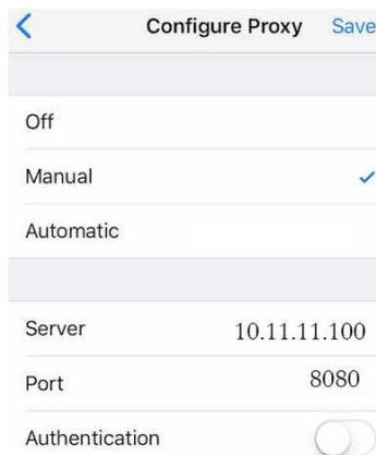
Figura 39: Configuración de proxy en terminal iPhone
