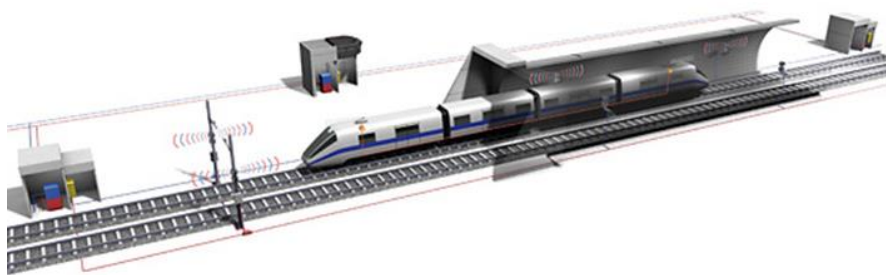
Figura 4. Equipamiento de vía y a bordo del tren en un sistema CBTC [5]
