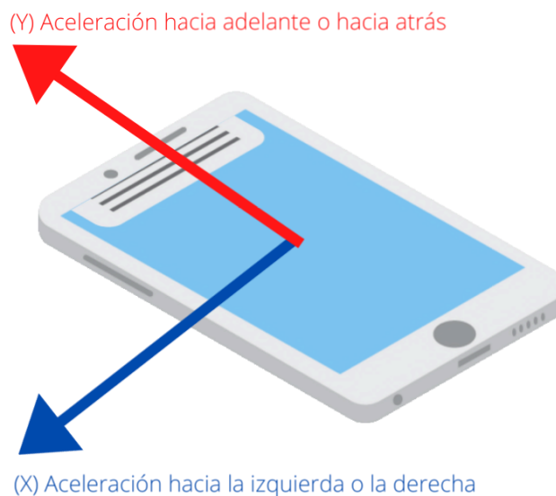
Figura 44 Dirección de la aceleración con el móvil tumbado
