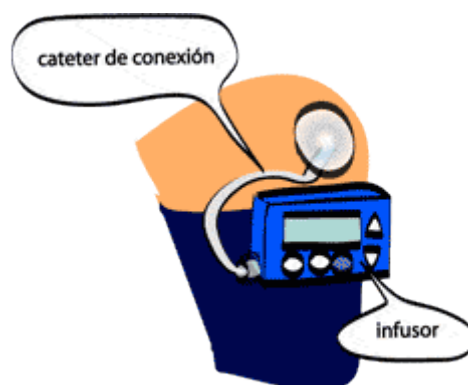
IL·LUSTRACIÓ 2. PARTS PRINCIPALS DE LA BOMBA DE INSULINA
