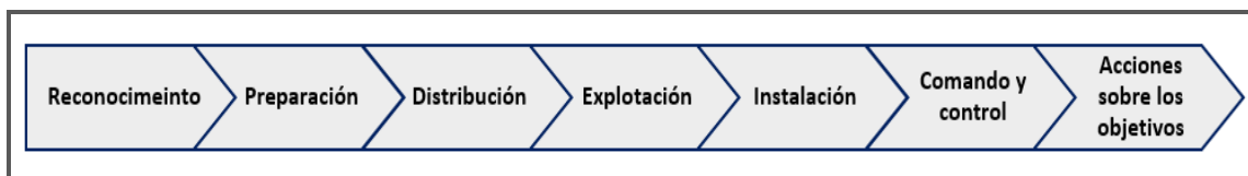
Ilustración 11 - Etapas del atacante según la cadena Cyber Kill Chain según Lockheed Martin.
