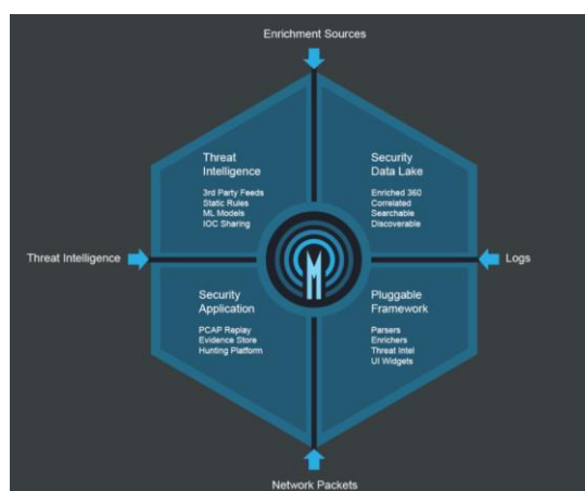
Imagen 26. Arquitectura simple de Apache Metron.
