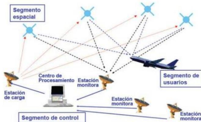
Ilustración 2-9 Funcionamiento de un GNSS
