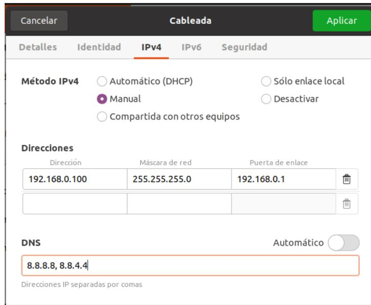
Figura 7: Ejemplo de configuración de red en la máquina “Worker1”
