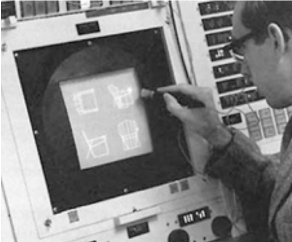
Sketchpad, un programari de dibuix de gràfics d'enginyeria per a l'ordinador TX-2. Creat el 1963 per Ivan Sutherland com a part del seu doctorat en el Massachusetts Institute of Technology. Va ser la primera interfície gràfica d'usuari per a ordinadors. Fotògraf desconegut. Aquesta imatge es reproduïx acollint-se al dret de citació o ressenya (art. 32 LPI), i està exclosa de la llicència per defecte d'aquests materials.
