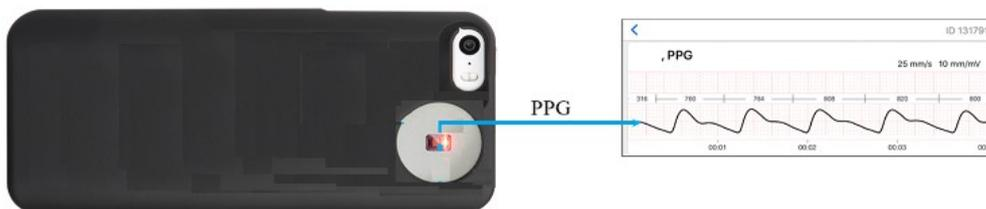
Figura 31. Medida con sensor PPG incorporado en Smartphone.
