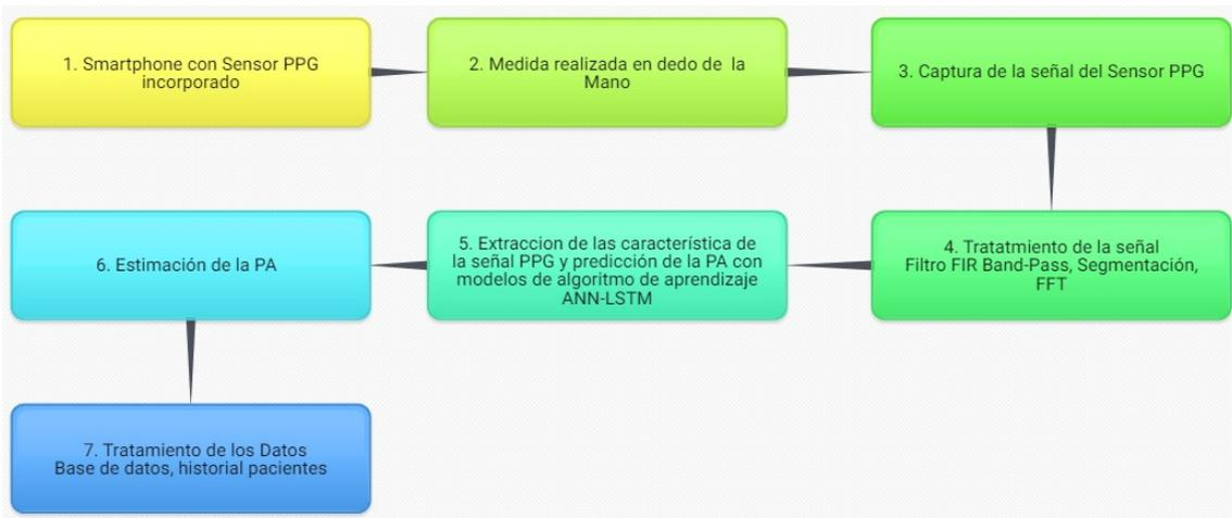
Figura 30: Diagrama desarrollo de la propuesta de un sistema de medida no intrusiva de la PA
