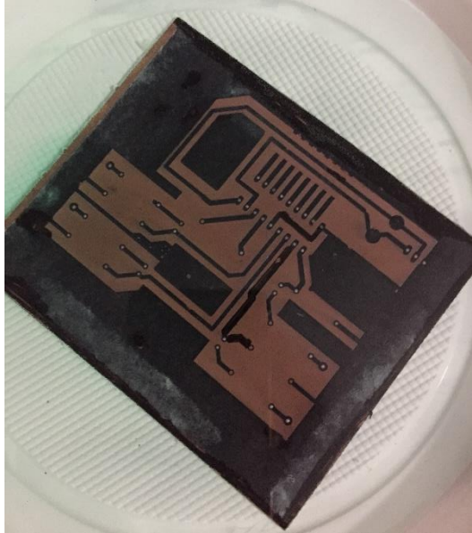
Ilustración 62. Primeros efectos del ataque al cobre.
