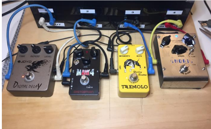
Ilustración 73. Cadena de efectos conectados al sistema receptor.
