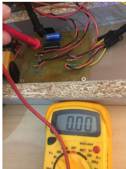
Ilustración 36. Tensión en las entradas del emisor en reposo.
