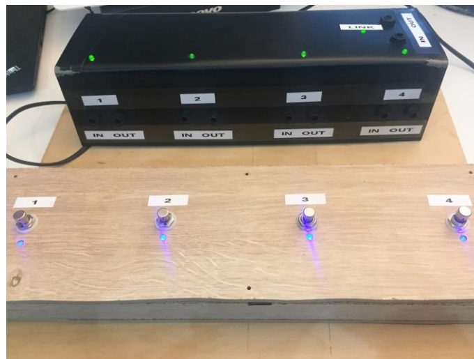
Ilustración 40. Comprobación visual con todos los switches encendidos.
