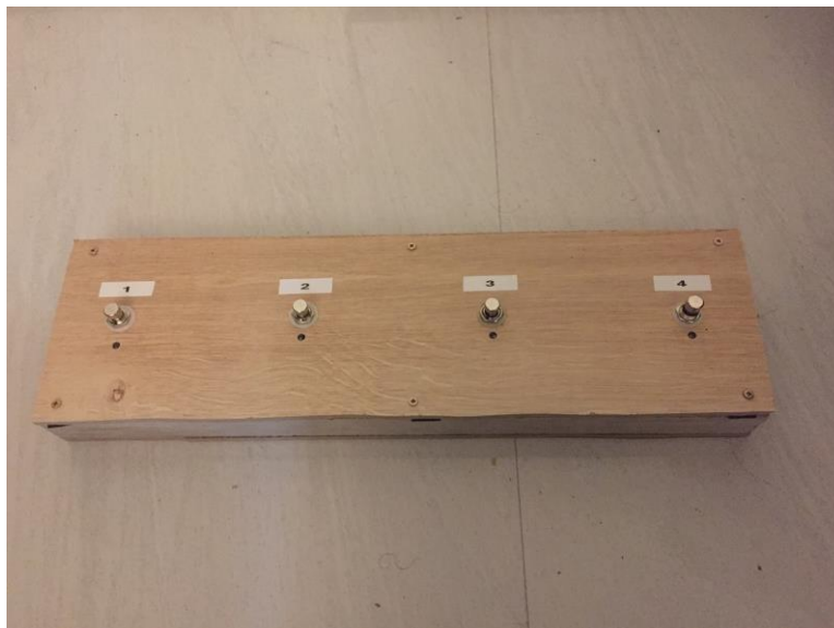
Ilustración 74. Emisor con detalle de los cuatro interruptores.
