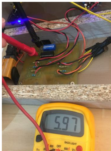
Ilustración 38. Tensión en las entradas del codificador, una vez activados los switches.
