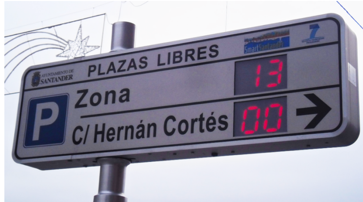
FIGURA 1 - PANEL INFORMATIVO SITUADO EN LA CALLE Y ALIMENTADO CON LOS DATOS DE LOS SENSORES QUE CONTABILIZAN LOS VEHÍCULOS
