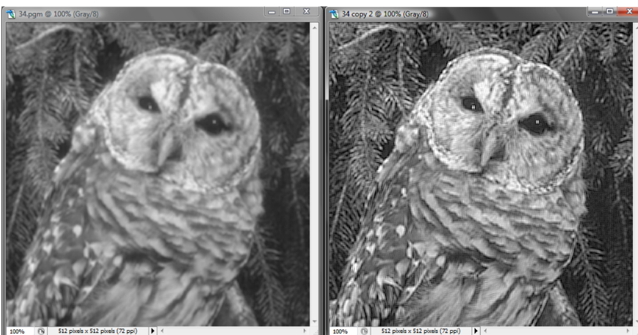
Figura 16. Enfocament: a) Imatge original desenfocada b) Després d'aplicar-hi realçament de contorns
