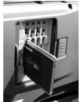
Secció corresponent a les ranures d'inserció de targetes P2 en una càmera Panasonic
