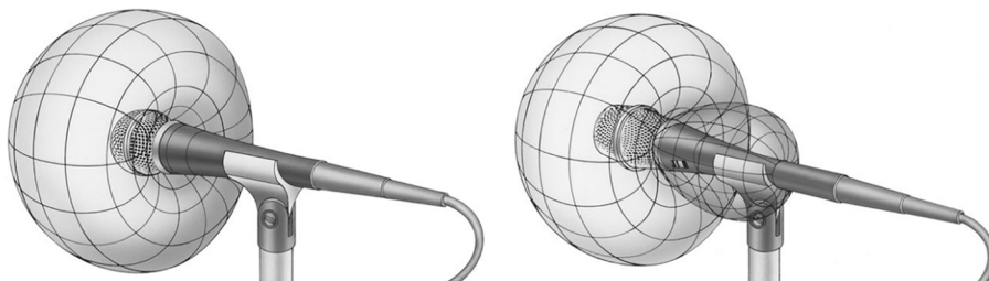
Figura 7. Diagrames de radiació en 3D de micròfons combinats de pressió i gradient: patró cardioïde (esquerra) i patró supercardioïde (dreta)
