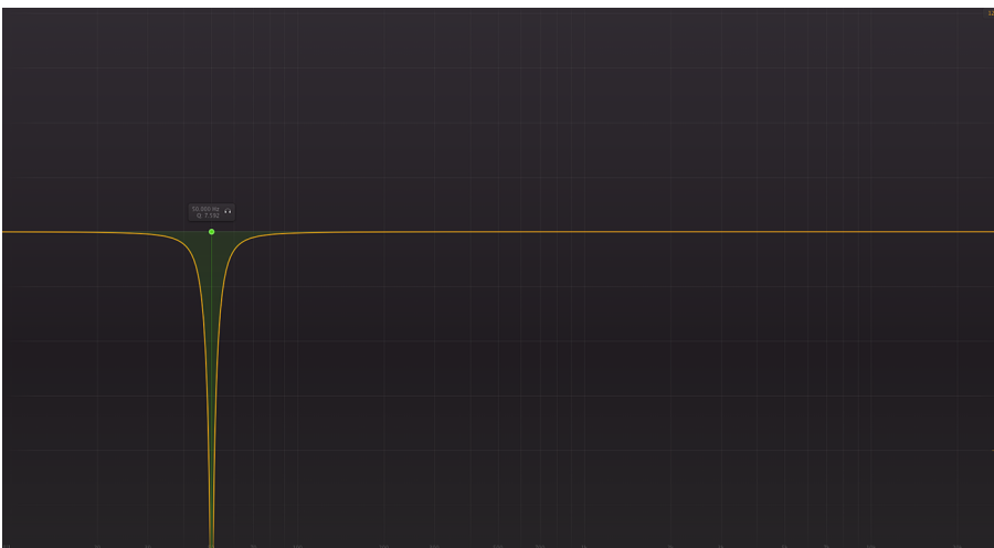
Figura 28. Resposta en freqüència d'un filtre rebuig-banda sintonitzat a f_o = 50 kHz
