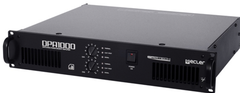
Figura 9. Amplificador de potència per a aplicacions professionals. Aquest model empra transistors MOSFET en una configuració classe AB (veure apartat 2.4)
