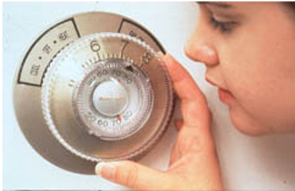
Figura 11. Un termostato con números grandes, marcas táctiles y sonidos como ejemplo de información perceptible
