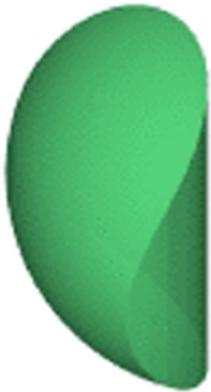
**3) Sustracción.** Uno de los dos objetos desaparece, restando al que queda la parte superpuesta. Recorta la parte en contacto. Permite determinar cuál de los dos objetos realizará la sustracción sobre el otro (A-B o B-A).
