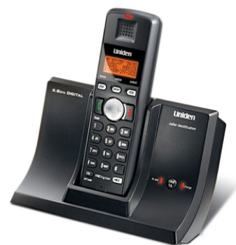
El DECT opera en la banda de freqüències que va de 1.880 MHz a 1.900 MHz.
