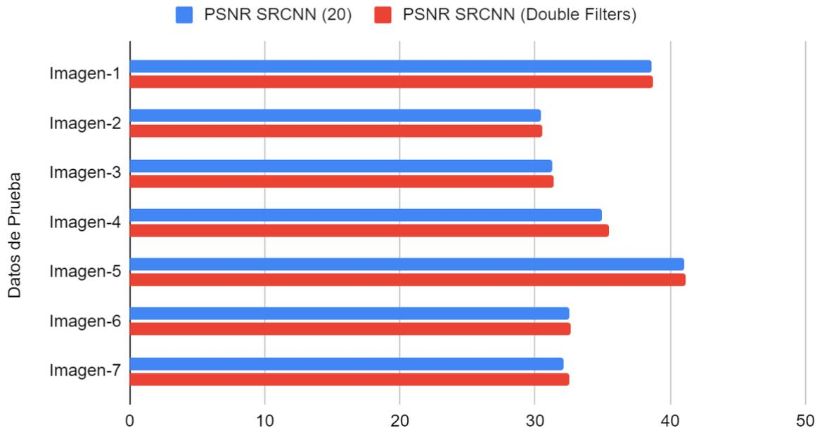
Figura 43: Comparativa entre el *PSNR* para imágenes bicúbicas y las del modelo del quinto entrenamiento
