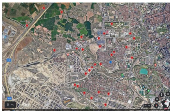
Figura 32: Puntos medidos con gateways Chirpstack.
