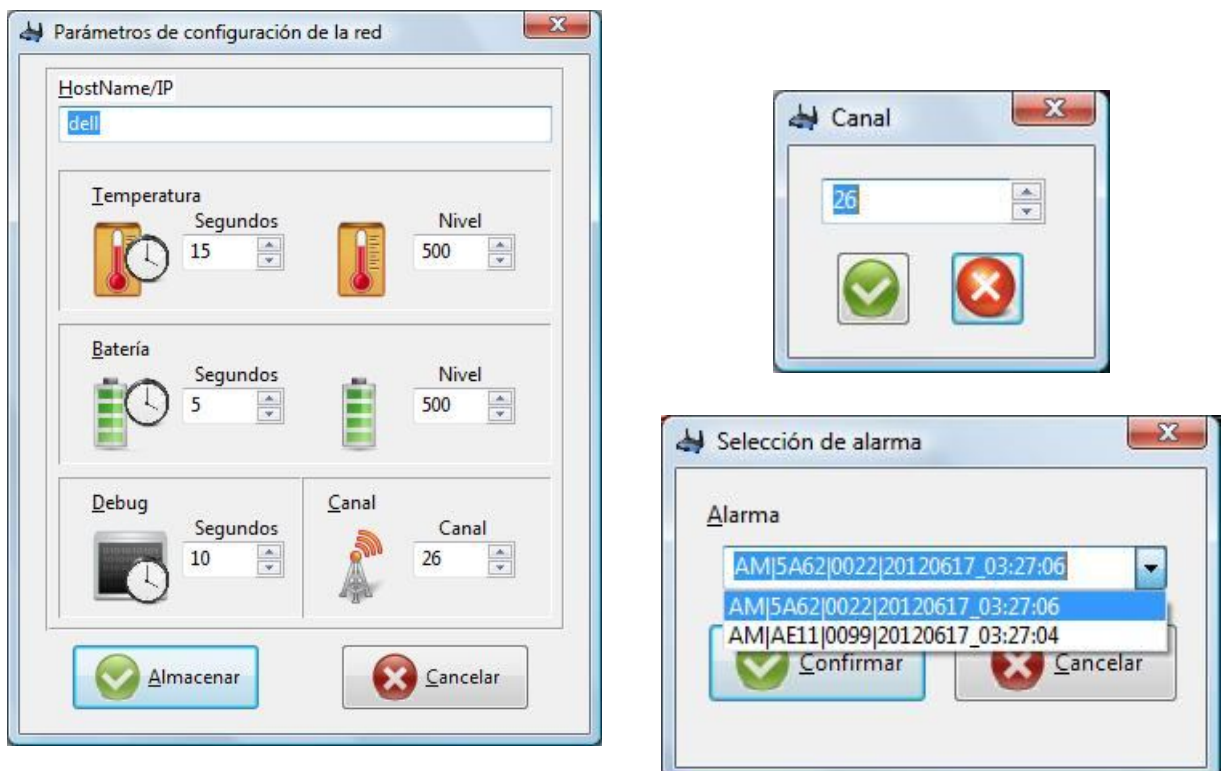
Ilustración 8 – Pantalla principal de la aplicación de control y configuración
