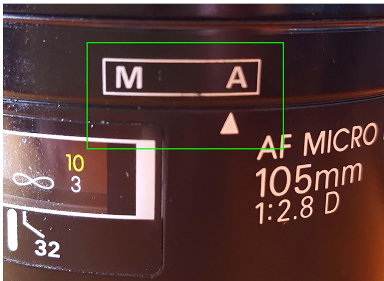
Commutador de focus manual-automàtic a l'òptica
