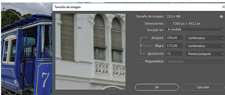
La fotografia del Tramvia Blau a 72 píxels per polzada de resolució. La imatge impresa té unes dimensions de 259 × 174 cm. El pes de l'arxiu és el mateix perquè no s'han eliminat píxels, només se n'ha redistribuït la concentració. És important que la casella Remuestrear no estigui activada per fer la modificació de la resolució sense que es perdin píxels.
