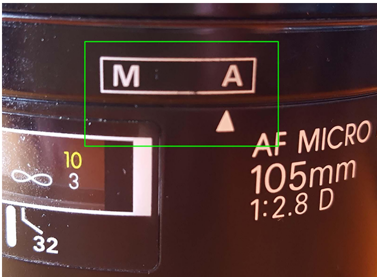
Conmutador de foco manual-automático en la óptica
