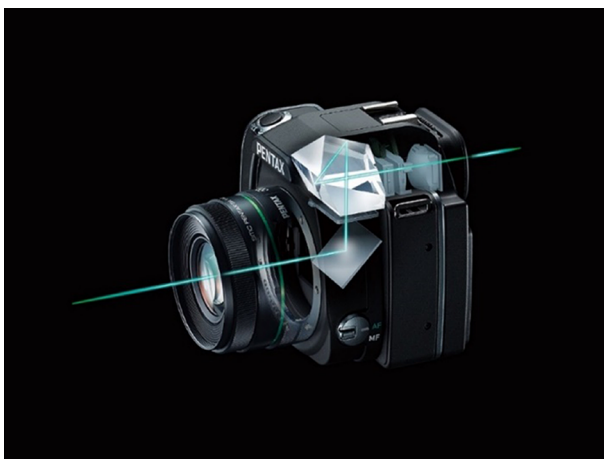
Espejo y prisma en una cámara réflex
