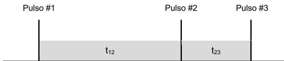
Figura 5.3. Digitalización en función de la separación entre tres pulsos consecutivos. Bit = '0' si t_{23} < t_{12} y Bit = '1' si t_{23} > t_{12}
