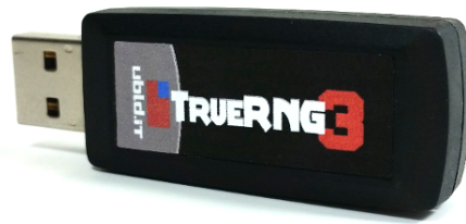
Figura 2.1. Dispositivo TRNG basado en el efecto avalancha en semiconductores, con una tasa de generación de 400 Kbits/s. [2]
