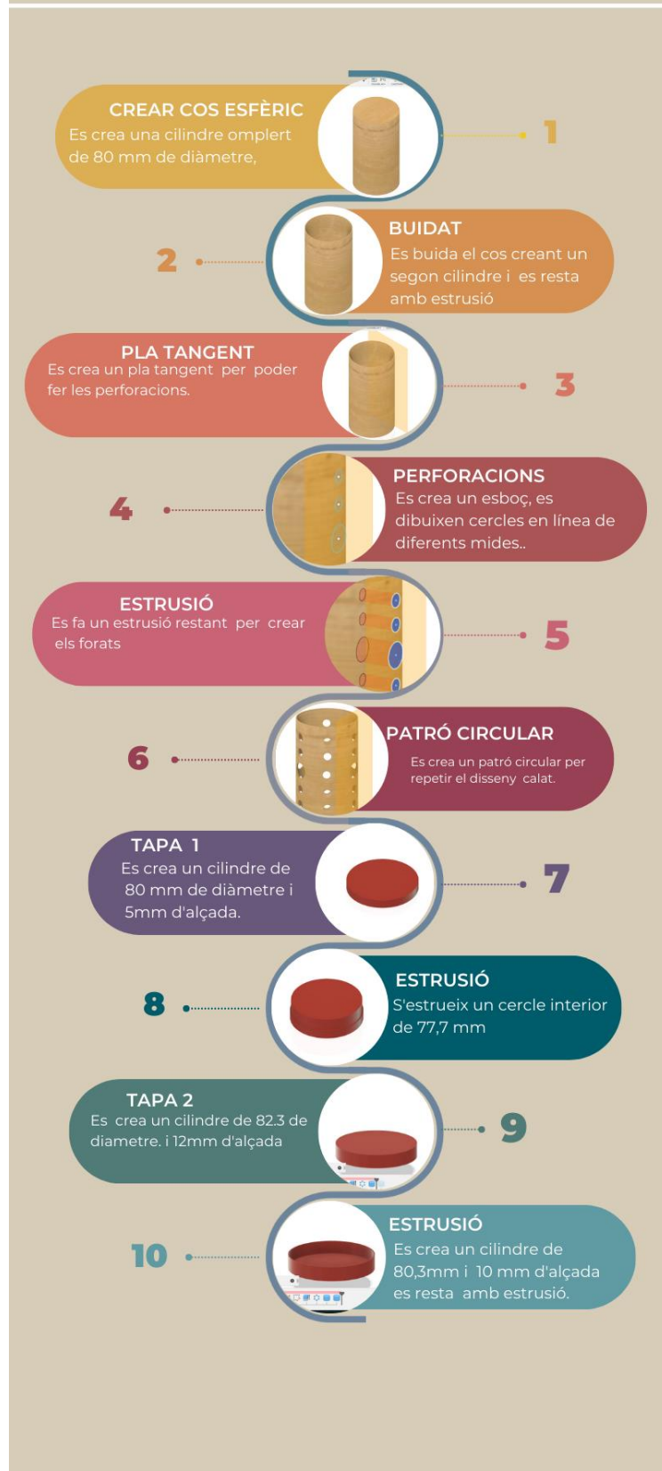
Figura 66 Procés bàsic de modelat dels tubs i tapes
