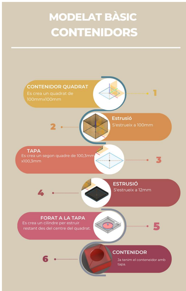
Figura 83. Procés bàsic de modelat dels contenidors. .
