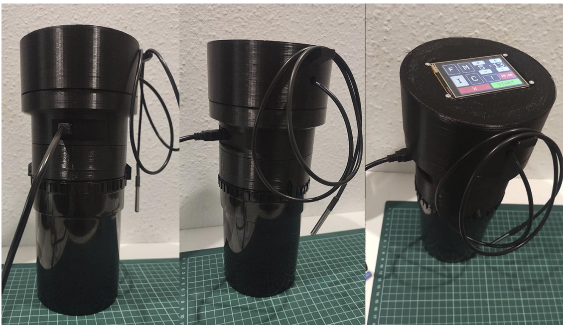
Figura 42: Dispositiu finalment acoblat al tanc de revelatge AP APP321100
