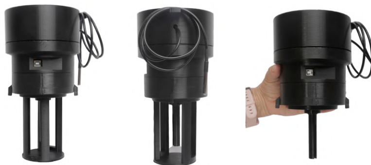
Figura 5: Tanc de revelatge intel·ligent, dispositiu final
