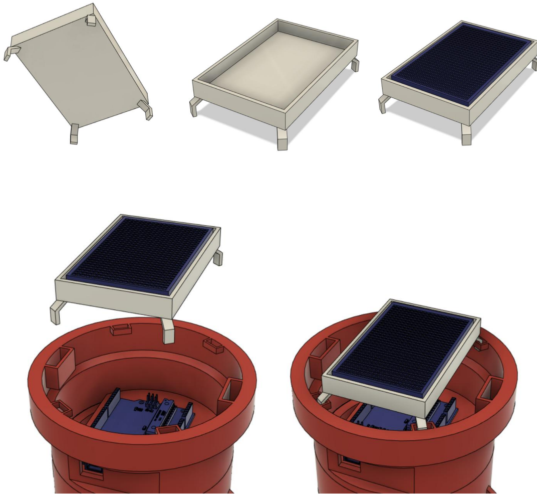
Figura 26: Acoblament de la superfície a la Base 2
