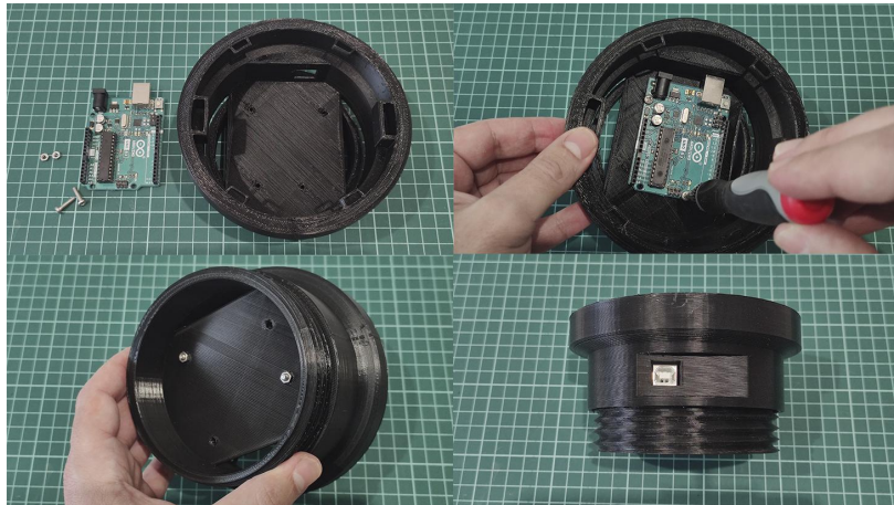
Figura 39: Acoblament d'Arduino UNO a la Base 2
