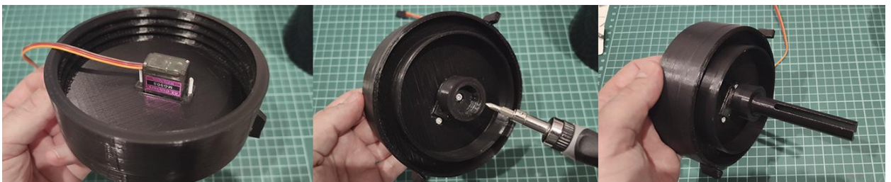
Figura 38: Fixació i acoblament del servomotor i eix a la Base 1
