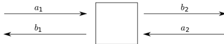
Figura 4. Ports entrada/sortida d'una antena
