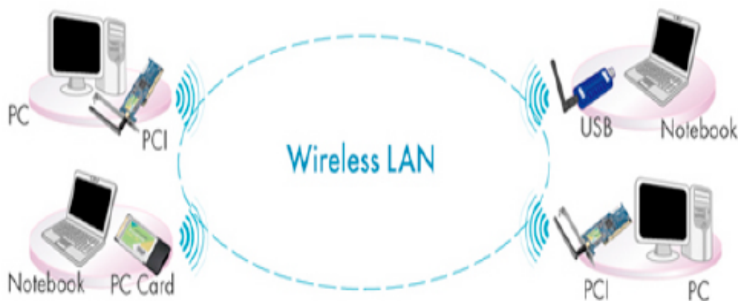
Figura 2.5. Esquema de connexió en mode Ad-Hoc [1]
