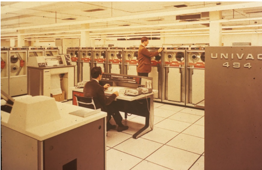
Figura 15. Univac 494. Operador assegut enfront de la consola central i operador dempeus davant unitats de cinta
