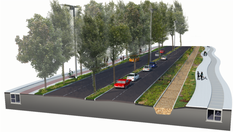
Figura 13. Sección tipo de una vía urbana sostenible
