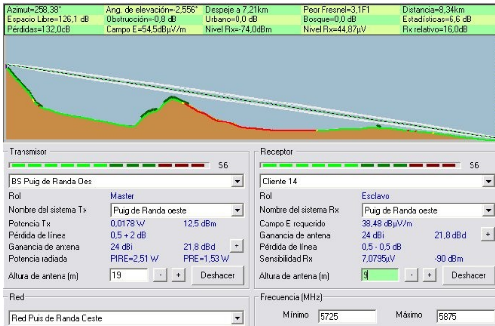
Ilustración 26: Análisis enlace entre BS Puig de Randa Oeste y Cliente 15
