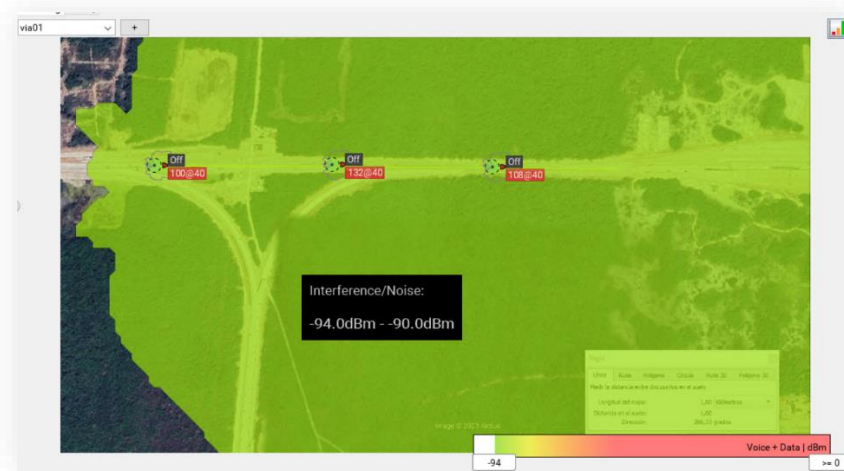
Figura 138 – Simulación vía – nivel de interferencia/ruido (mejor disposición de canales)
