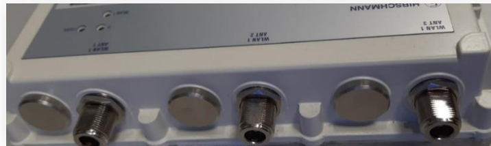
Figura 67 – Detalle de los puertos RF (ant1, ant2 y ant3)
