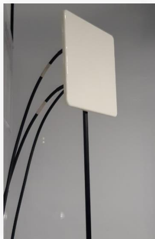
Figura 96 – Antena (MIMO 3x3) conectada con 3 cables RF al AP y al cliente
