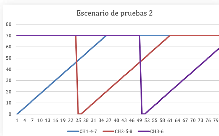
Figura 114 – Diagrama de atenuación de señal en escenario 2
