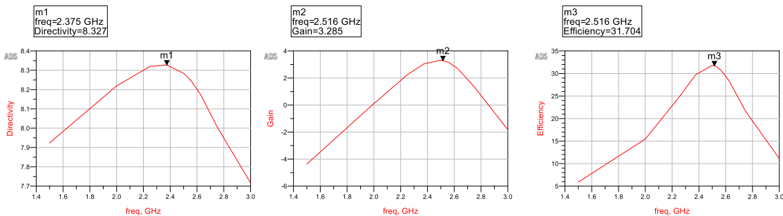
Fig. 55 Ganancia, Directividad y Eficiencia patch
