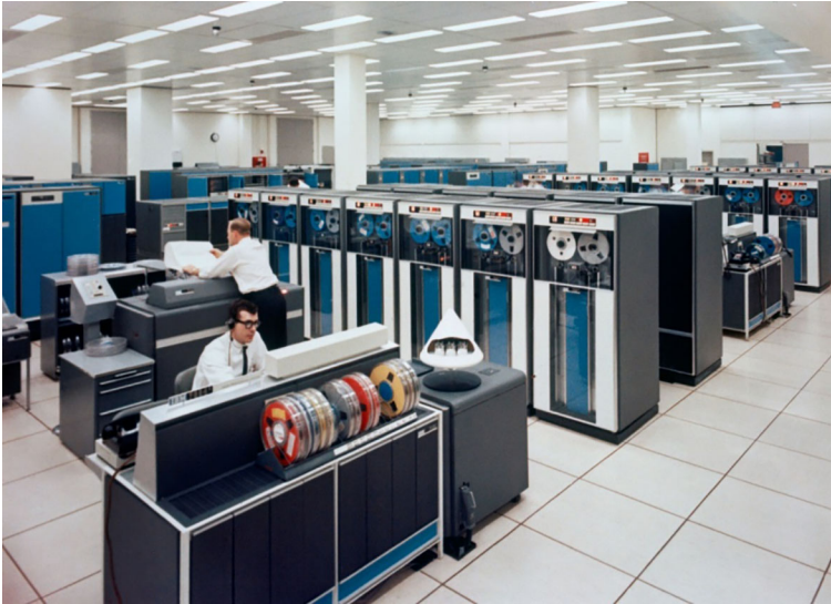
Figura 1. Mainframe modelo 3090 de IBM, introducido en el año 1985.
