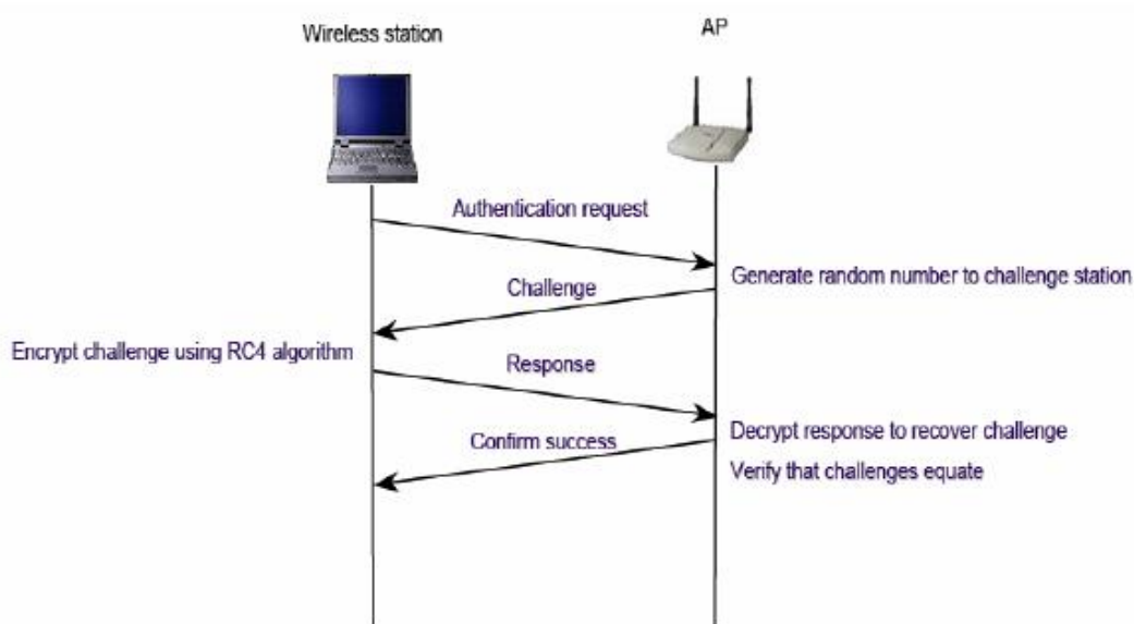
Figura 4.1 Mètode d'autenticació WEP Shared Key Authentication
