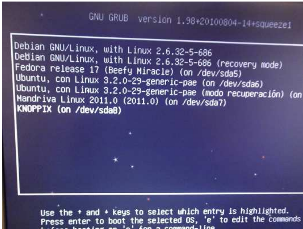
Figura 2: Menú cargador de arranque generado por Debian6.0.6
